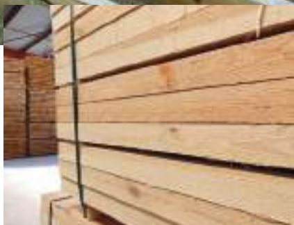
Bois de structure brut – pin sylvestre de France – C24 avant traitement autoclave.
